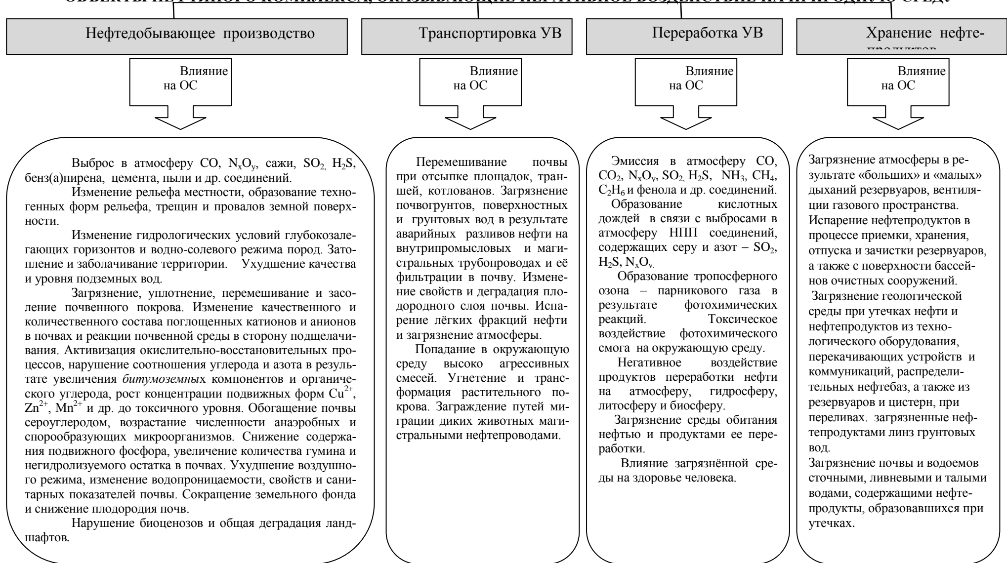
Рис. 1. Принципиальная схема воздействия объектов нефтяного комплекса на природно-антропогенную среду
